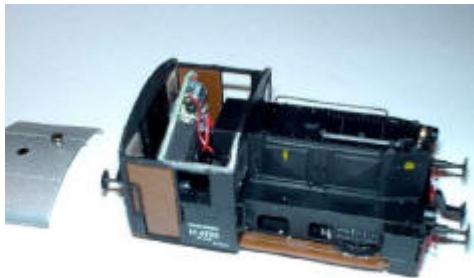
Hier sieht man den Decoder, welcher im Führerstand problemlos Platz findet.
